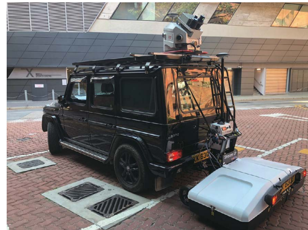
▲ 透過使用透地雷達勘察地下水管情況
