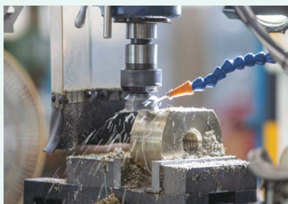
▲ 車間維修人員可按各機械損耗情況製造零件
