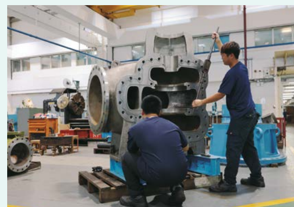
▲ 維修人員正檢測泵浦的接合面
