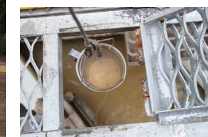
▲ 水務署職員定時抽取水樣本化驗，以監測原水水質，檢測包括物理、化學、細菌學、生物學和輻射等水質參數。
