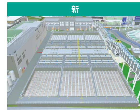
▲ [新] 高速沉澱池
