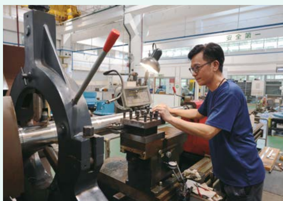
▲ 維修人員正校對泵浦葉內的中心線
