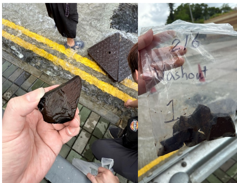
圖 3.4 房屋署於 6 月 2 日在皇溢樓對開迴旋處後的位置 沖洗喉管時收集到的黑色沉積物
