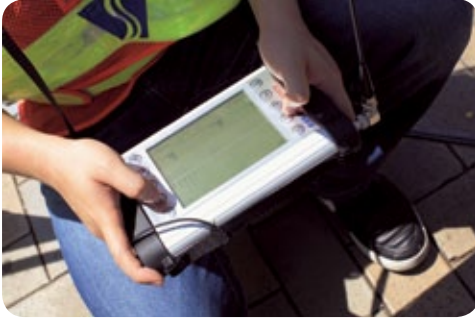
漏水噪聲相關儀。 Leak noise correlator.
