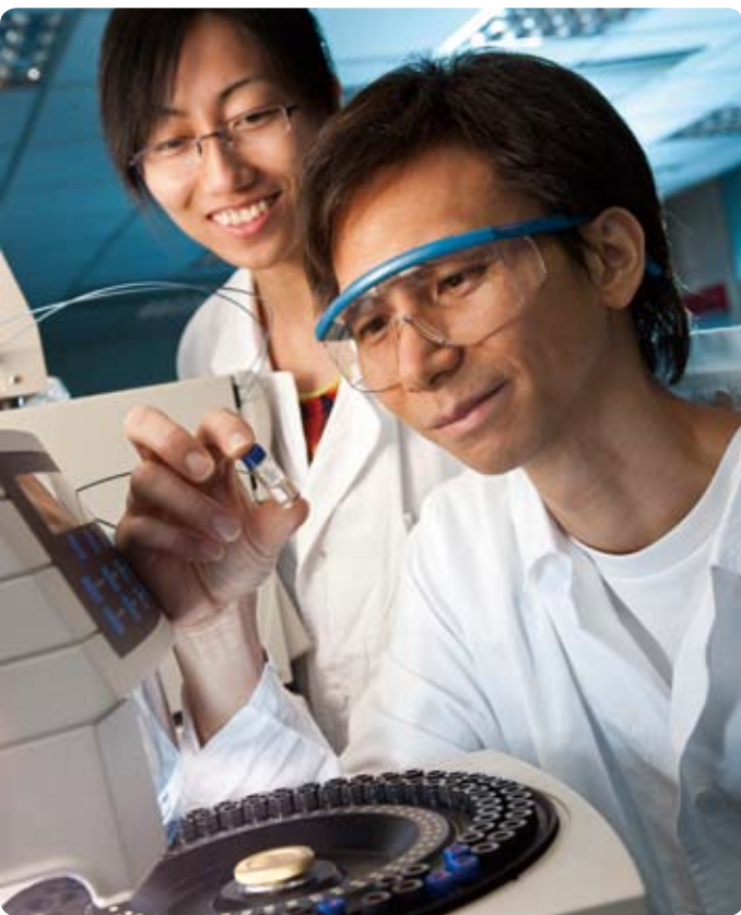
水質化驗人員以離子色譜儀測試水質樣本。 Using ion chromatograph to test water sample.
