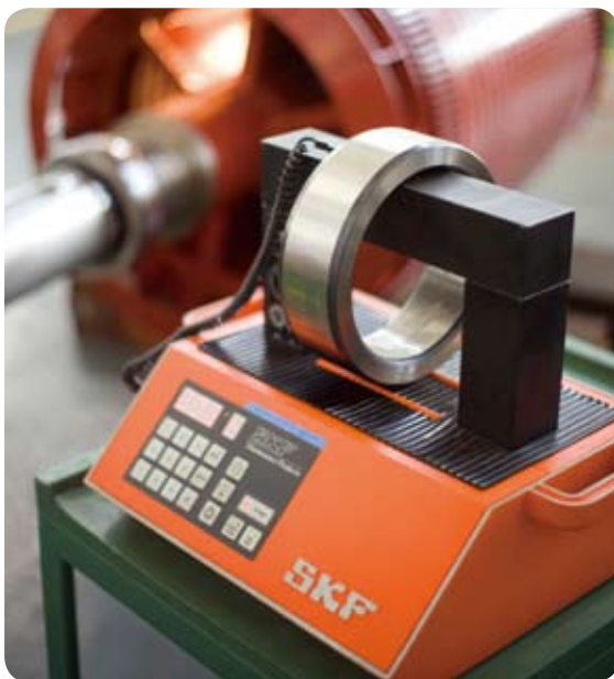
在電機工場使用的電感發熱器。 An induction heater used in the Electrical Workshop.
