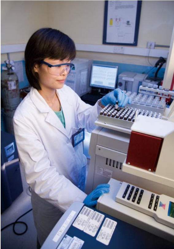
進行氣相式譜儀分析。 Staff performing gas chromatographic analysis.
