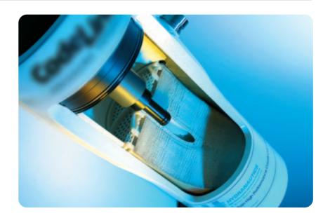
▲ 在屯門海水化淡試驗廠內使用的薄膜管道樣本。 A sample of membrane tube used in the desalination pilot plant at Tuen Mun.
