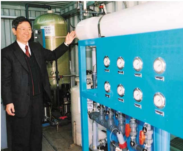
助理水務署長／發展古志眾先生向傳媒介紹利用逆滲透科技將海水淡化的試驗廠。
