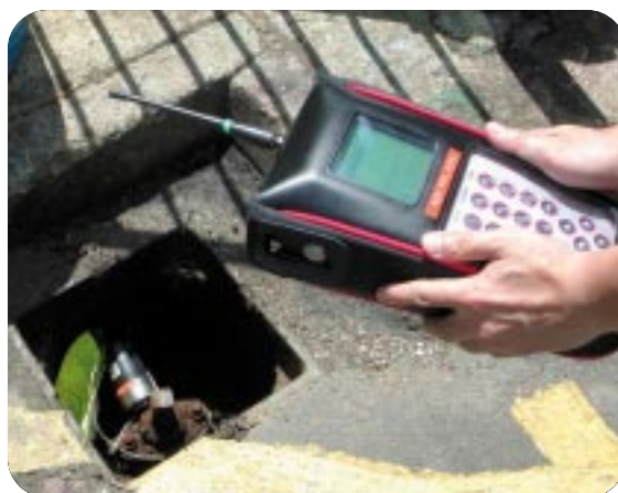
自動為水管測漏的 Permalog 聲音數據記錄儀及巡邏接收器。 Permalog Noise Loggers and Patroller Module for detecting pipe leaks.
