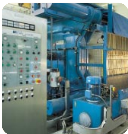
製造泥餅的壓濾機。 Filter press for making sludge cakes.
