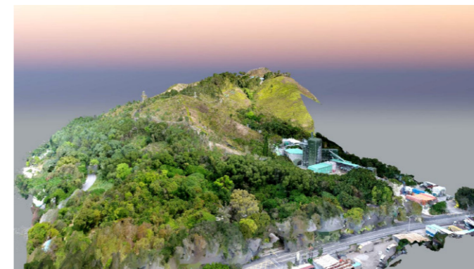
運用專業軟件將航拍照片合併，製作三維模型及正射影像，方便用家在電腦自由選擇，以不同的角度查看
