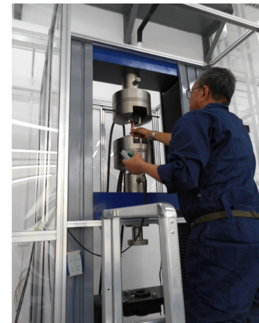
利用萬能材料試驗機(UTM)進行喉管拉力測試
