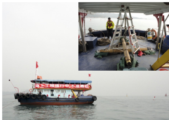
工程船在海上航行（小圖為定位儀裝置）
