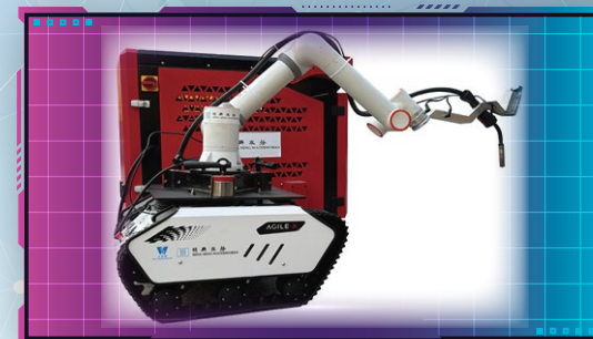
圖三：「智管焊」配備靈活的機械臂
