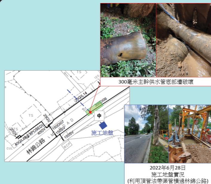
圖一：林錦公路的300毫米主幹供水管遭鄰近地盤施工破壞，圖為其緊急維修工程的詳細圖
