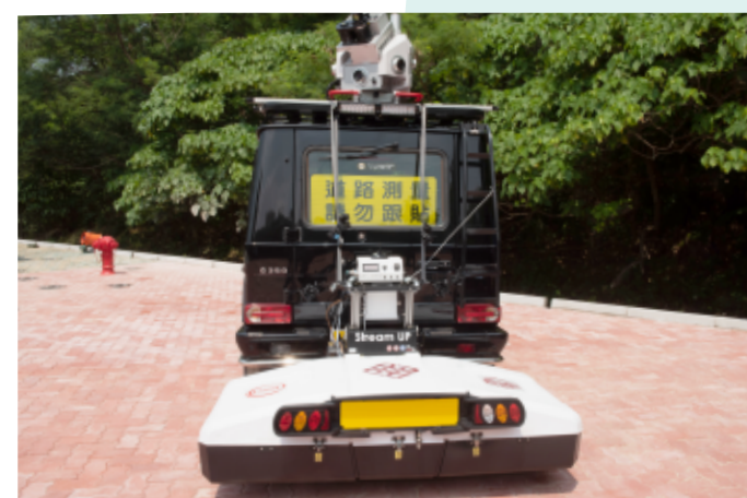
理工大學展示「多通道透地雷達」，可用於探查地下滲漏的水管。
